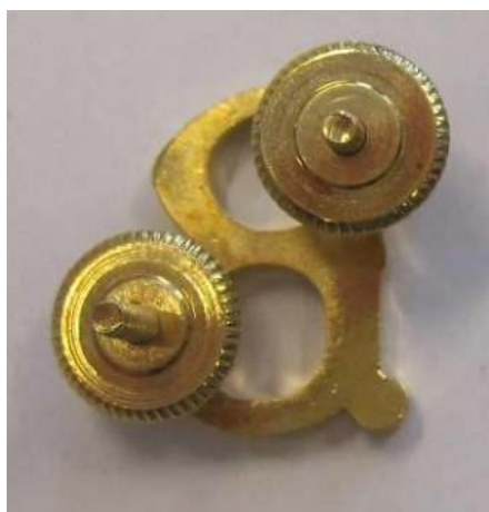
Diagonale plaatsing schroefstiften achterzijde voor klein formaat
